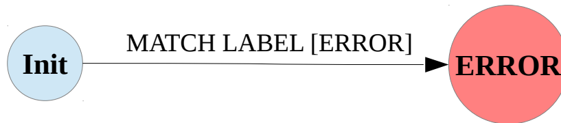
Рис. 4.2. Автомат, переходящий в ошибочное состояние при достижении метки ERROR .
