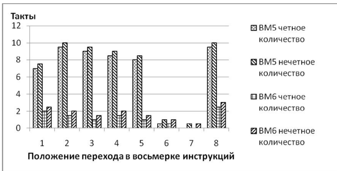
Рис. 5. Задержка выполнения команд перехода в тактах для микропроцессора 1890VM8 с буфером инструкций на 12 команд
