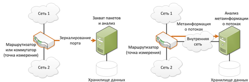
Рис. 7 - Различия типичных схем packet (слева) и flow-based (справа) анализа.
