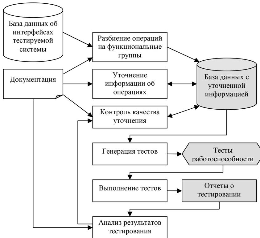
Рисунок 1. Схема выполнения работ по технологии Azov.
