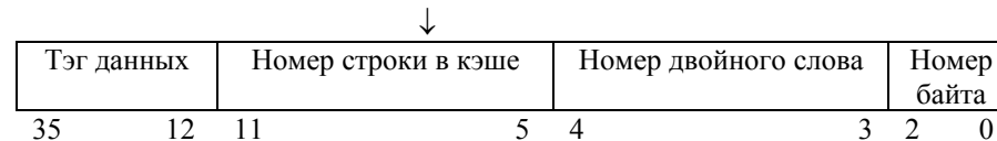
Рис. 2. Формат физического адреса в RM7000.
