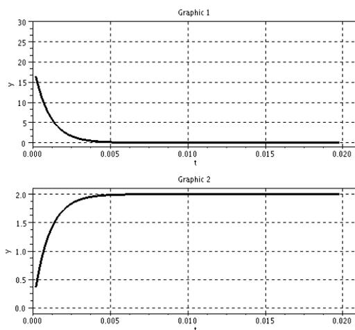
Рис. 7: Переходный процесс в RL-схеме. График 1 – график напряжения на индуктивности. График 2 – график тока на индуктивности
