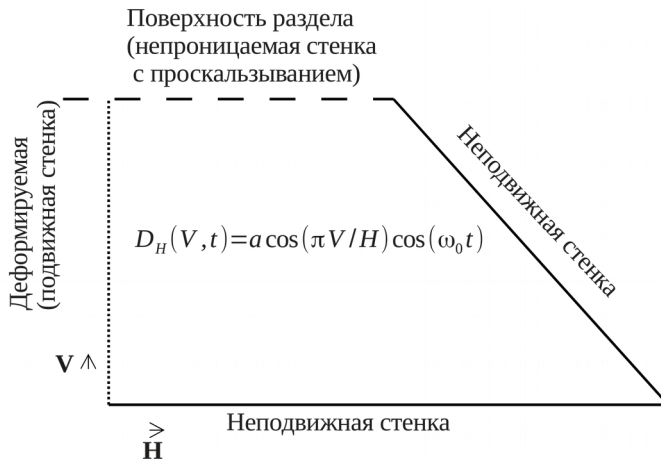
Рисунок 2. Принципиальная схема расчётной области и физических внешних границ
