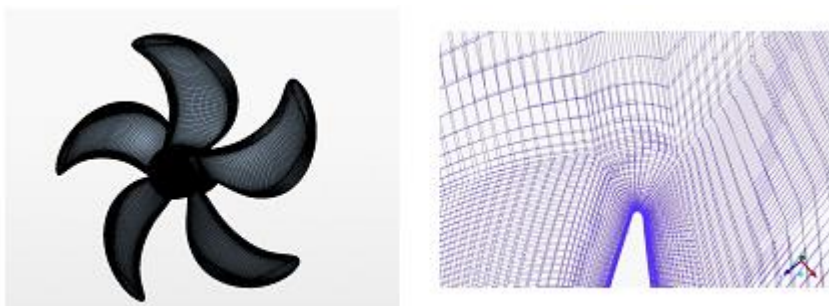
Рис. 2. Расчетная сетка на поверхности гребного винта и фрагмент расчетной сетки в окрестности кромки лопасти винта.
