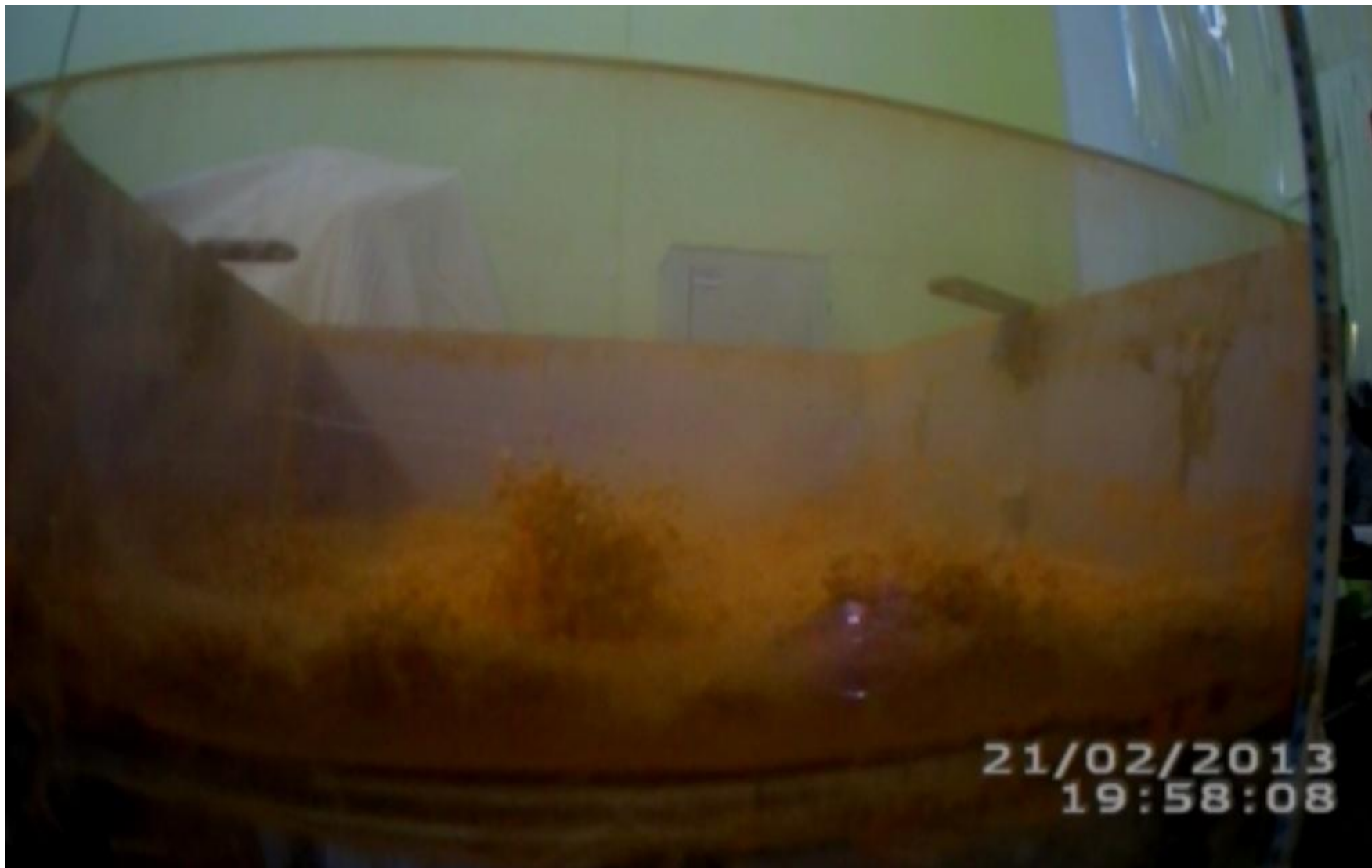
Рис. 3. Виброкипящий слой. A = 2,5 мм, f = 32 Гц.
