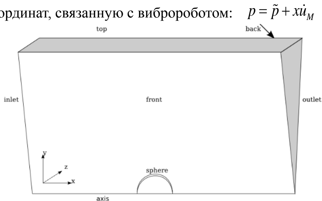
Рис 7. Расчетная область Размеры в пл. OXY :50x15
