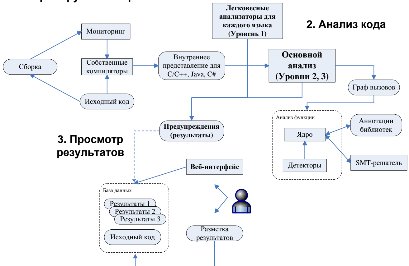
Рисунок 2. Организация и схема работы анализатора Svace.
