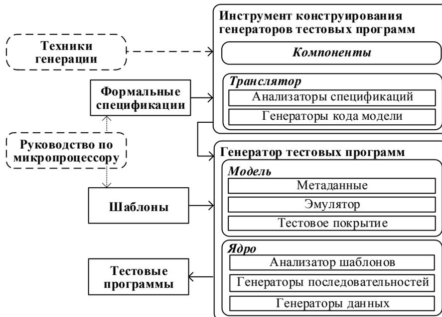
Рисунок 4. Инструмент, реализующий предлагаемый метод, и результат его работы
