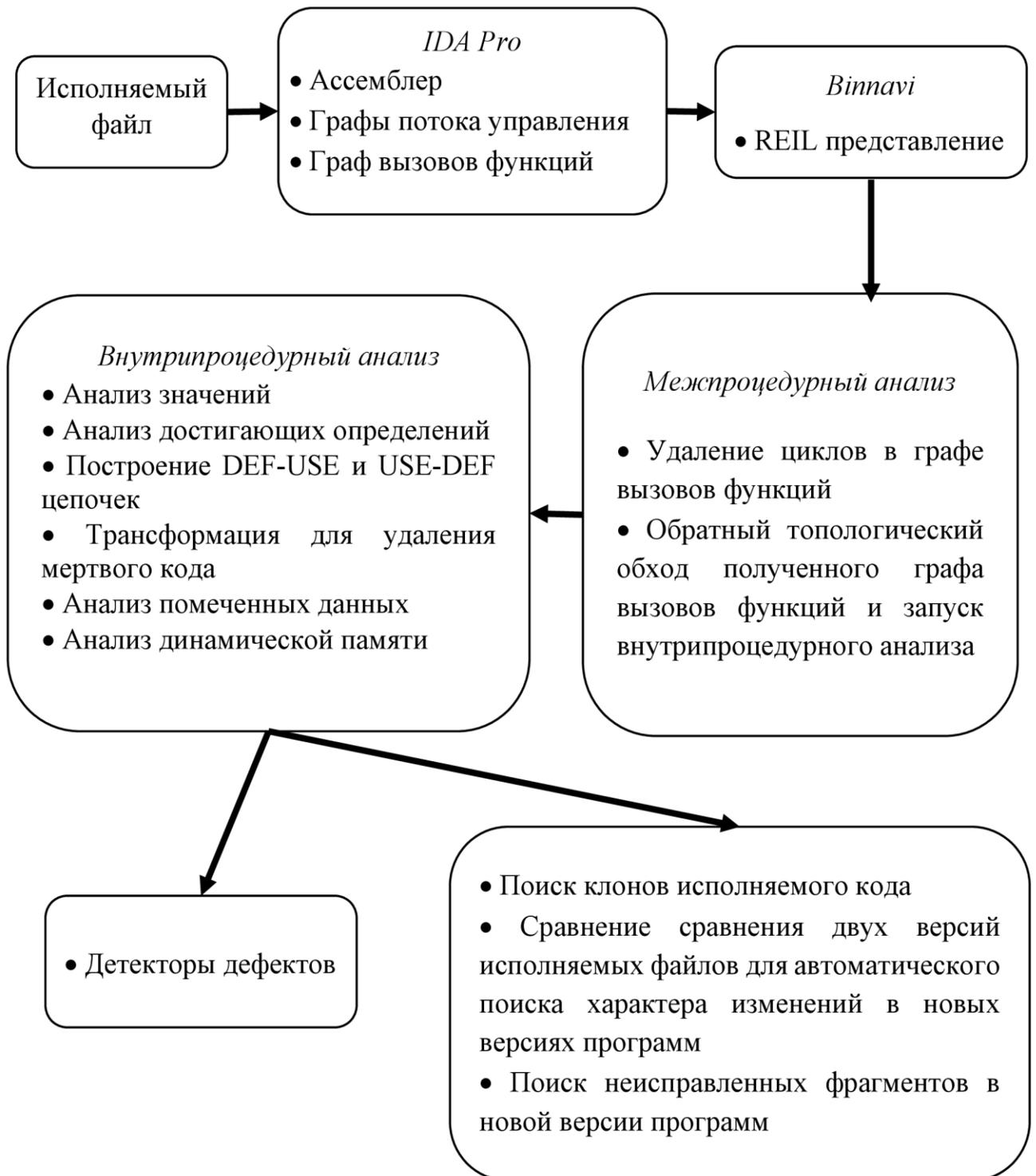
Рисунок 2. Архитектура статического анализа исполняемых файлов
