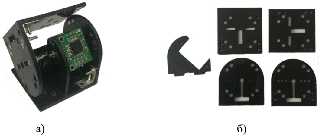
Рис. 3.3.1. а) Внешний вид разработанного макетного образца типового мехатронного модуля, б) разработанные детали конструкции.
