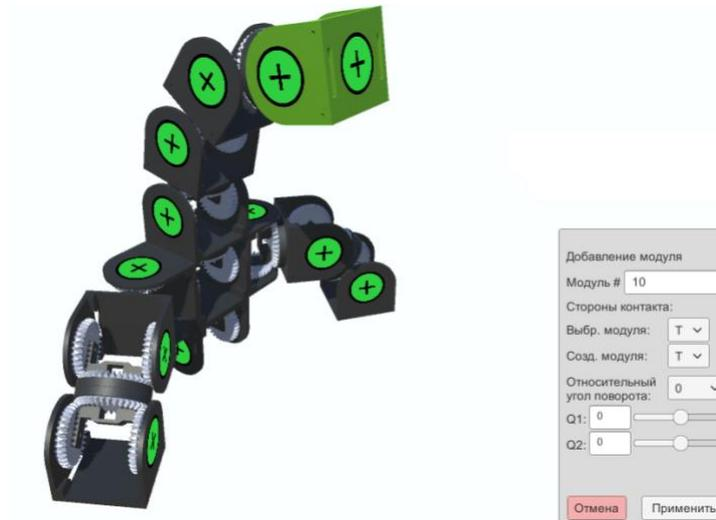
Рис. 3.2.2. Пример формирования программной модели мехатронно-модульного робота в режиме «визуального конструктора».
