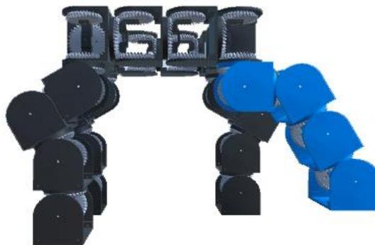
Рис. 2.2.5. Представление конечности шагающей платформы в виде модульного манипулятора.
