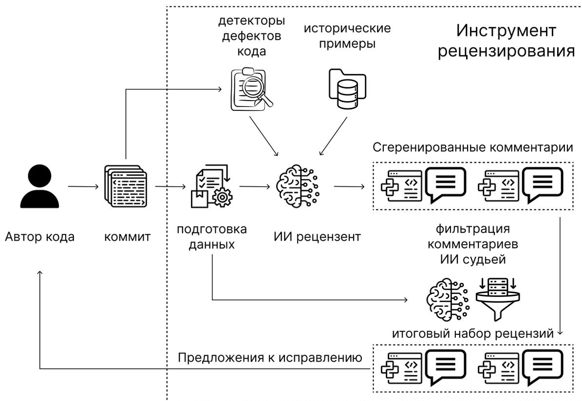
Рисунок 3: Схема работы системы автоматического рецензирования
