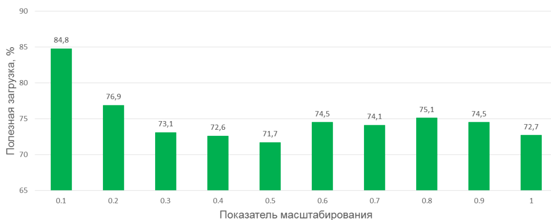
Рисунок 36 – Гистограмма полезной загрузки в зависимости от показателя масштабирования (однородный поток высокой интенсивности flow2-0.90, НРО 30%). Больше – лучше
