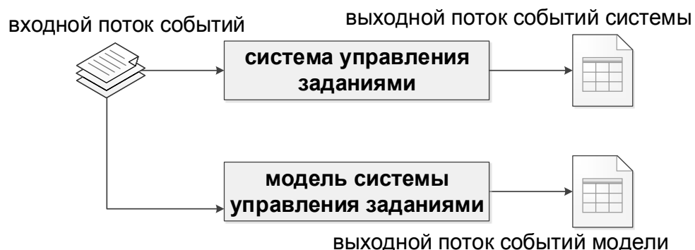
Рисунок 16 – Схема применения имитационной модели СУЗ в реальном времени
