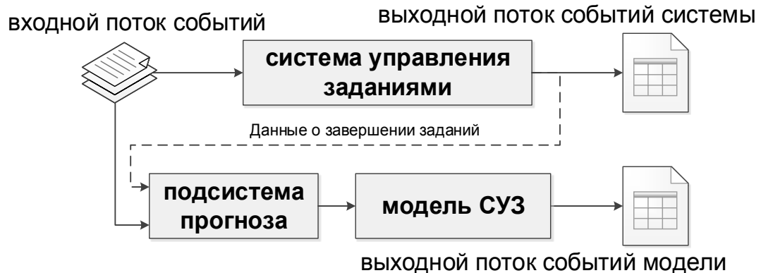
Рисунок 19 – Применение модели СУЗ в реальном времени с подсистемой прогноза и обратной связью
