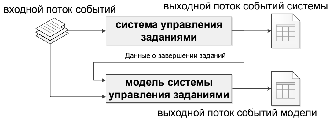
Рисунок 17 – Схема применения имитационной модели СУЗ в реальном времени с обратной связью
