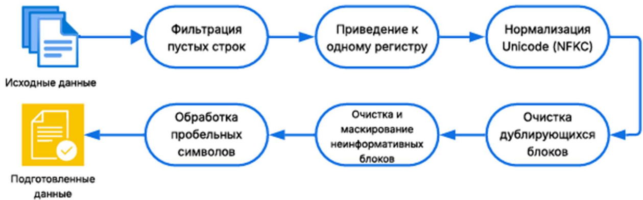
Рисунок 3.3 – Модуль предварительной обработки и нормализации событий
