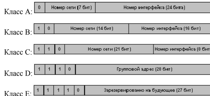
Рис. 1. Форматы адресов IPv4
