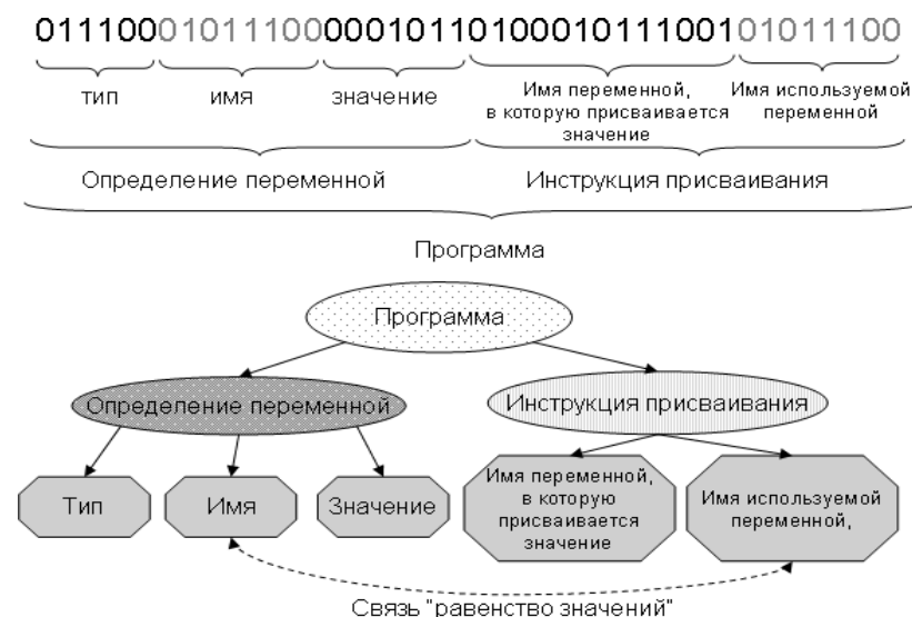
Рис.1. Представление данных сложной структуры в виде последовательности бит и в виде атрибутивного дерева.
