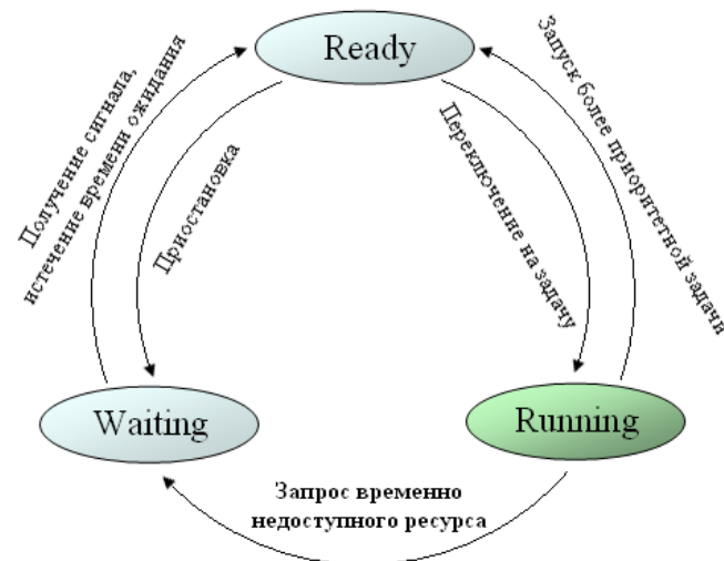
Рис.1. Схема переключения состояний задач
