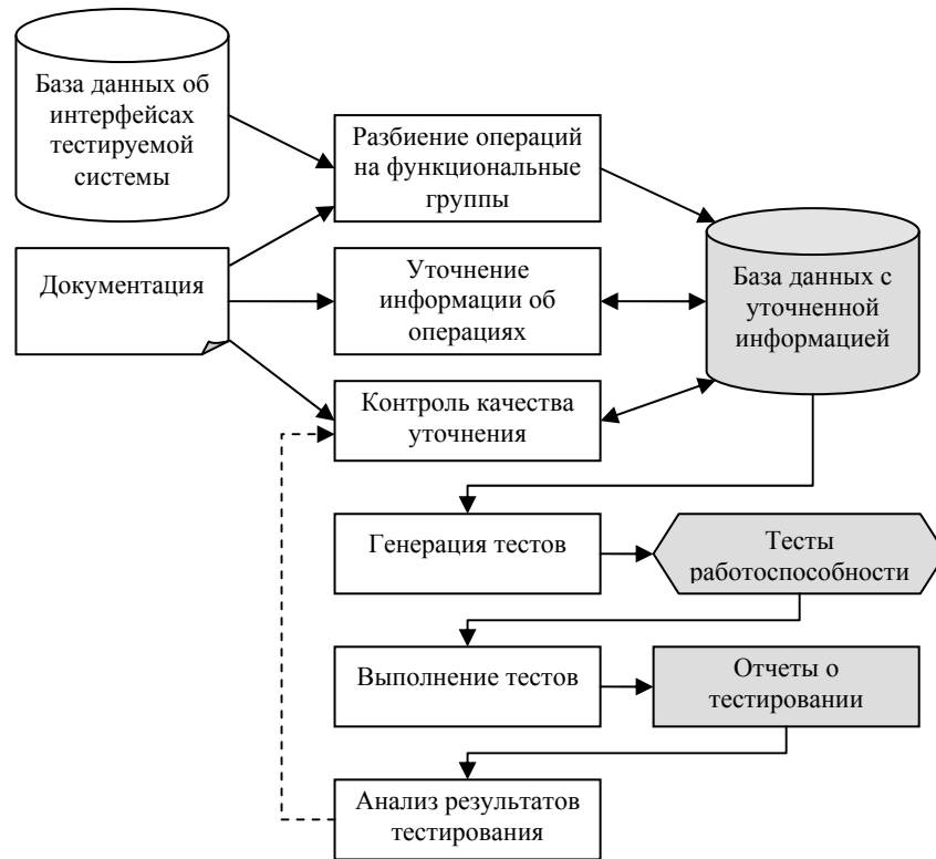
Рис. 1. Схема выполнения работ по технологии Azov.
