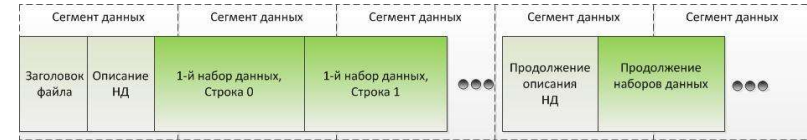
Рис. 4. Размещение данных в файле формата HDF5 Fig.4. The structure of HDF5 data
