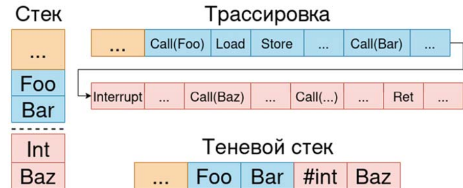
Рис. 6. Трассировка и теневой стек обработчика прерывания. Fig. 6. Tracing and shadow stack with interrupt handlers.
