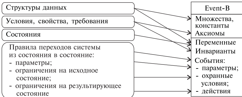
Рис. 4.2. Соответствие между компонентами МРОСЛ ДП-модели и Event-B
