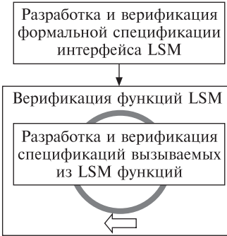
Рис. 6.3. Схема процесса верификации кода модуля LSM
