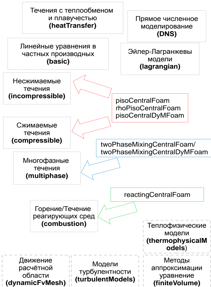
Рис. 1. Приложения-решатели, реализующие гибридный метод и расширяющие стандартный набор моделей пакета OpenFOAM
