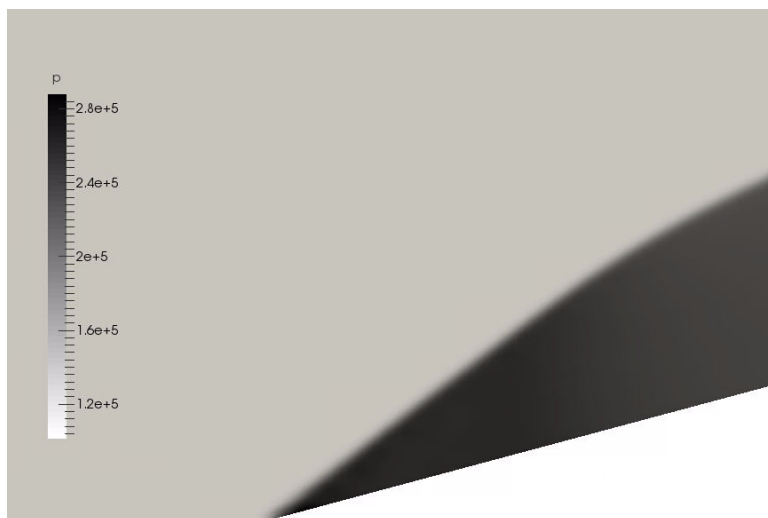
Рис. 7. Поле давления при обтекании косого уступа сверхзвуковым потоком
