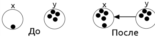
Рис. 2. Ситуация до и после добавления ребра, соответствующего ограничению для x := u , а также пропация типов.
